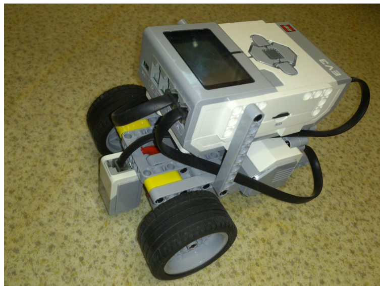
Obrázek 3.4. Robot sledující černou čáru
